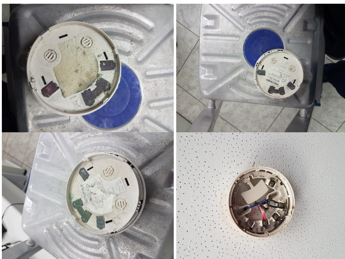
Figura 27. Detectores de Fumaça com oxidação interna.
